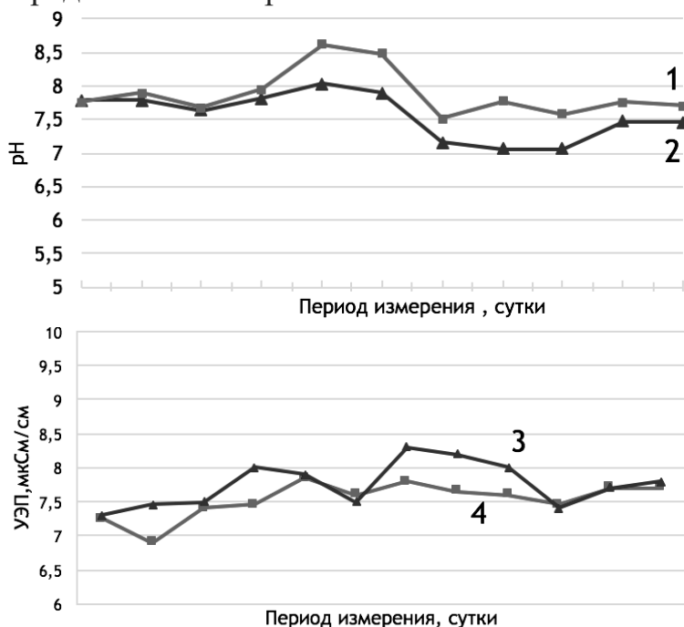
Рис.1 Изменение рН и УЭП за период измерения (дозирование Моноэтаноламина): 1- исследуемый рН-метр; 2-эталонный рН-метр ;3-исследуемый кондуктометр;4-эталонный кондуктометр
